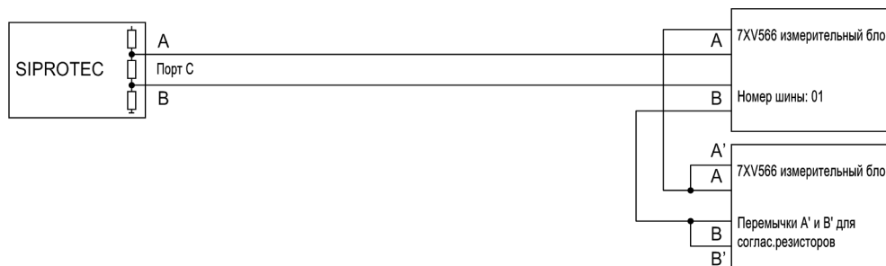
Рисунок А-20 Электрическое подключение (RS485) двух измерительных блоков
